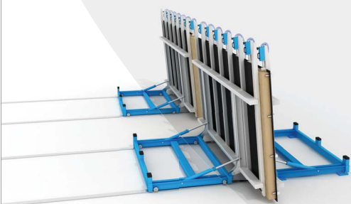
3 - fermeture des tables et transfert du panneau sur la seconde table
