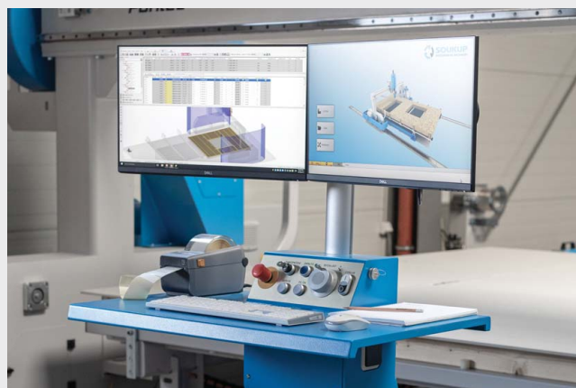
Integrovaný průmyslový počítač Beckhoff se dvěma velkoplošnými monitory; řízení NCI
