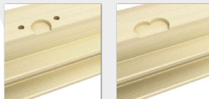
Creusage des charnières des fenêtres
