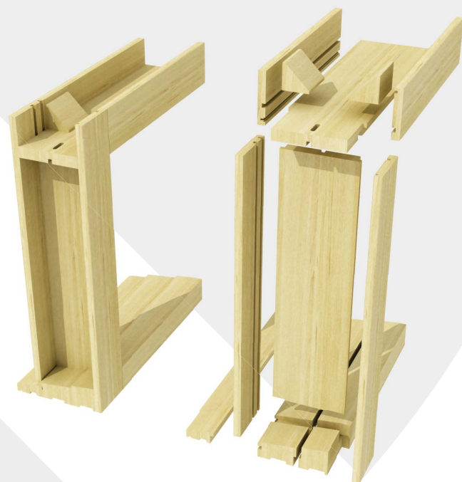
Les boîtes coulissantes fabriquées à partir des tasseaux profilés sur la machine Crafter.
