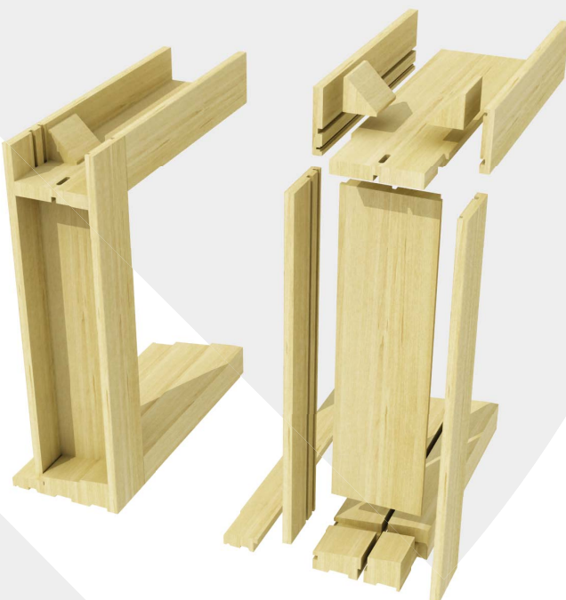
Cajas deslizantes hechas con molduras perfiladas en la Crafter
