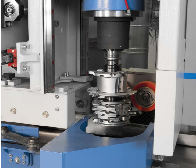
Unidad perfiladora con procesamiento por ambos lados
