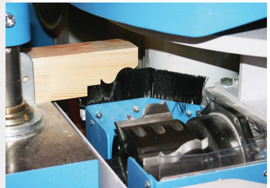
Unidad de fresado horizontal para cuernos y operaciones de ranurado
