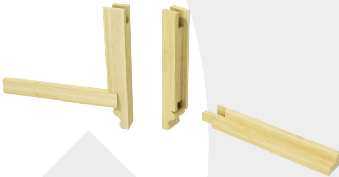
Procesamiento de largueros de confluencia biselados y montantes con cuerno (margen sobrante) mecanizado
