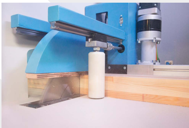
Dispositivo de sujeción lateral y superior para un corte preciso
