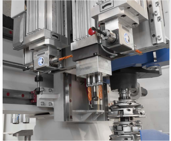
Huso de formación de espigas con unidades perforadoras
