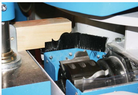
Horizontální frézovací jednotka pro konce křídel posuvných oken - přísl. pro verzi E Horizontal milling unit for heritage sash horn detail - E series optional
