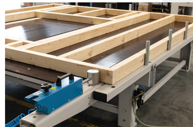
Pneumatické upínače se silou 1200 N (6 barů)
