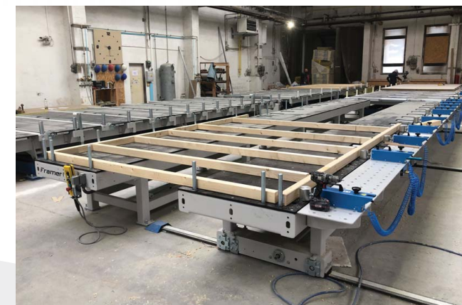
Integrované válečky pro manipulaci s rámem
