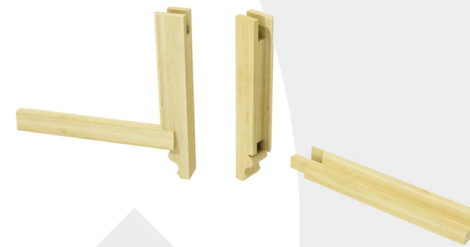
Keresztelemelek és félfák megmunkálása csapos-részletekkel
