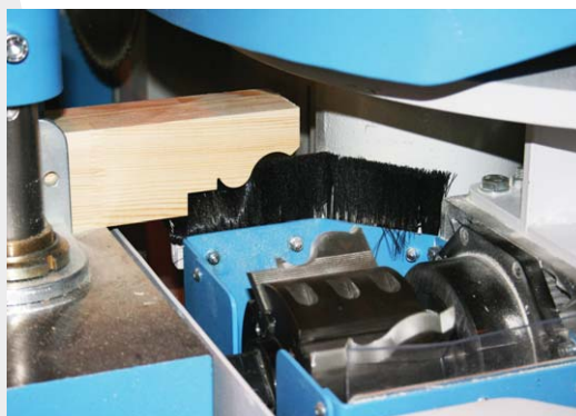
Poziomy agregat frezujący do obróbki rogów i rowkowania
