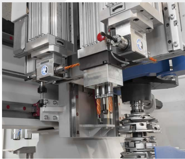
Wrzeciono czopujące z agregatami wierzącymi
