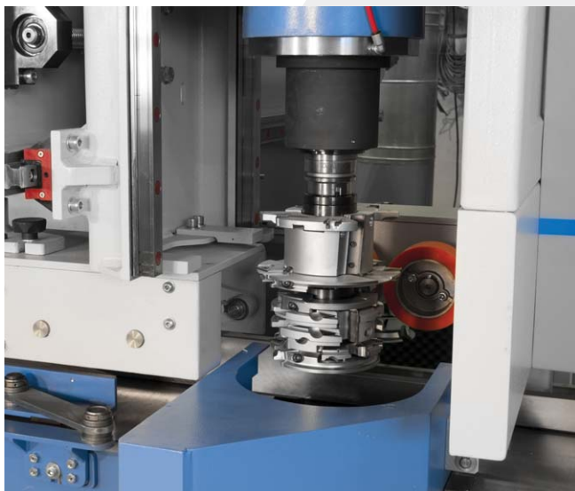
Agregat profilujący działający z obu stron
