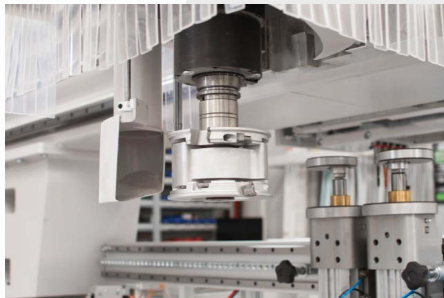
Vertikální elektrovřeteno HSK-F63 s C-AXIS pro agregáty na pracovní ose Y-1
