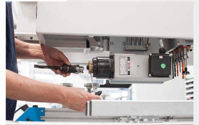
Rychlovýměnný systém HSK 40A (horizontální jednotka)
