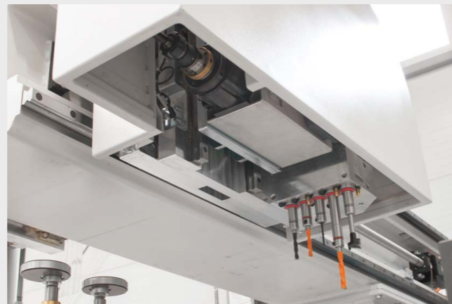
Vertikální pětivřetenová vyvrtávací hlava a horizontální frézovací jednotka s rychloupínacím systémem HSK 40A na pracovní ose Y-2
