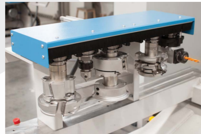
Lineární výměník nástrojů (6 pozic)
